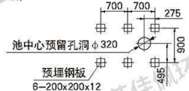
混凝土工作桥预埋件
